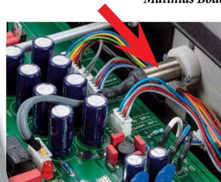
Die abschaltbare Kopfhörerbuchse (Pfeil) sitzt im Ausgangsbereich der Vorstufe (o.). Deren Fernbedienung ist jetzt in Metall gefasst
