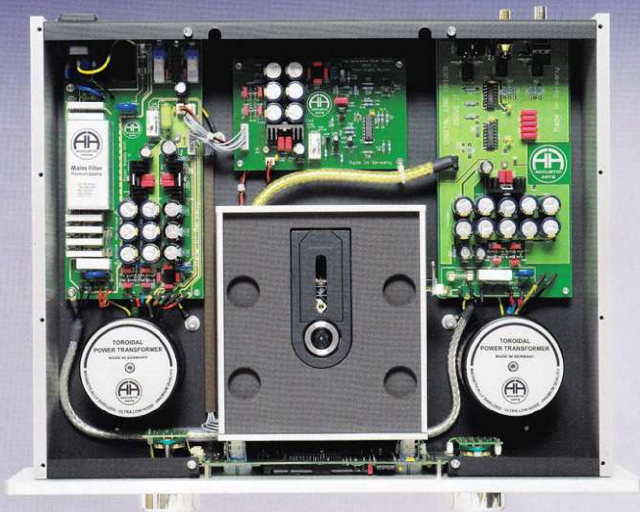
Le lecteur de CD utilise deux alimentations indépendantes : l'une pour le moteur du bloc optique proprement dit, l'autre pour les circuits de traitement du signal numérique
