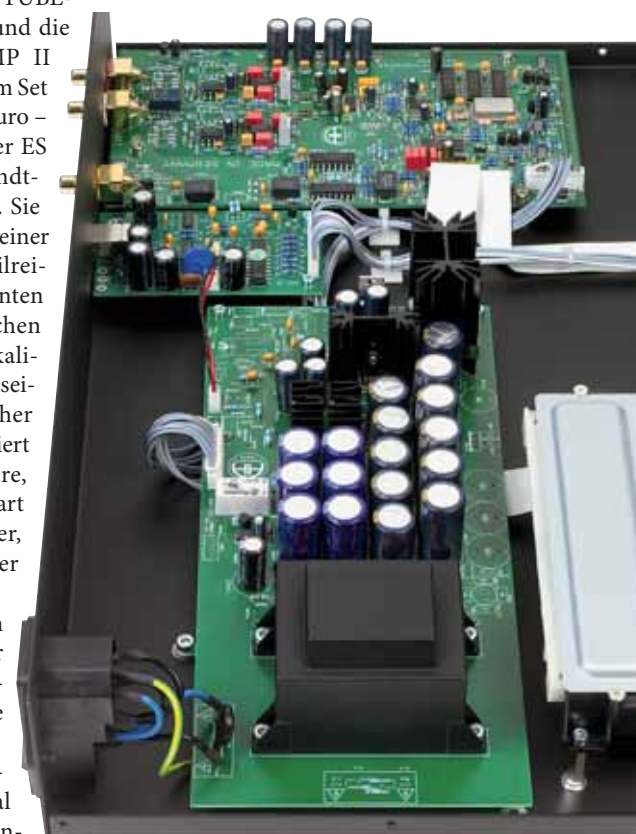
Das mit vier stabilen Spannungsversorgungen bestückte Netzteil-Board des Players zeigt den Aufwand. Sein Anschlussfeld ist puristisch besetzt (o.)
