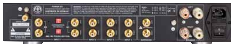
Über die roten DIP-Schalter zwischen den Phono-Eingängen werden MM- und MC-Typen vorgewählt. Das Anschlussfeld des POWER ES ist ebenso übersichtlich wie sein Innenleben, dessen hinteren Teil der Kühlkörper für die vier Endtransistoren samt Treibern einnimmt
