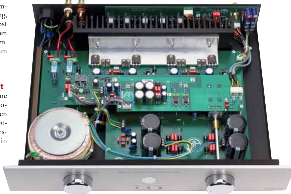
Über die roten DIP-Schalter zwischen den Phono-Eingängen werden MM- und MC-Typen vorgewählt. Das Anschlussfeld des POWER ES ist ebenso übersichtlich wie sein Innenleben, dessen hinteren Teil der Kühlkörper für die vier Endtransistoren samt Treibern einnimmt
